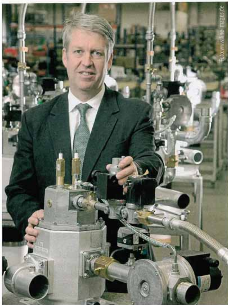
WS-Geschäftsführer Dr. Joachim Wüning mit einem Flox-Brenner. Die Erfindung ermöglicht ein energieeffizienteres Härten von Stahl.
